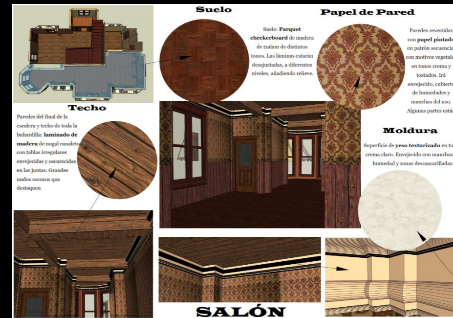
Fig. 06 - Casa Benet - Interior salón - Memoria de calidades
